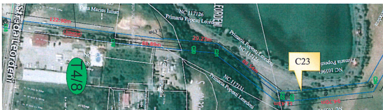
2.2.9 Camin vizitare C23, amplasat pe colectorul de canalizare cu Dn 1000 mm
