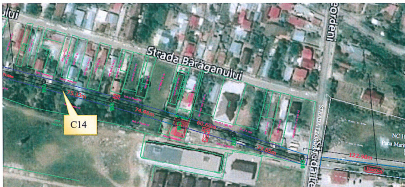
2.2.5 Camin vizitare C14, amplasat pe colectorul de canalizare cu Dn 1000 mm
